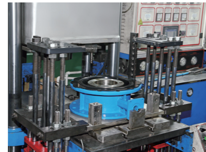
Надежная Герметичность клапана™ уплотнитель корпуса вулканизирован резиной EPDM
